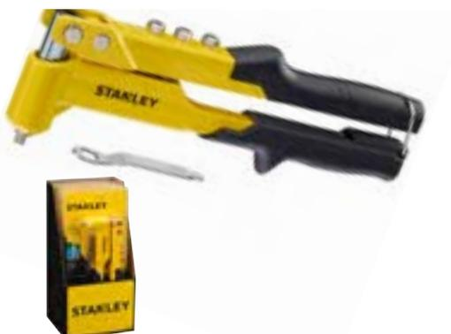
· Professionale. Corpo in metallo pressofuso. Impugnatura lunga per facilitare la compressione. Meccanismo a molla per l'espulsione della parte eccedente del rivetto.
